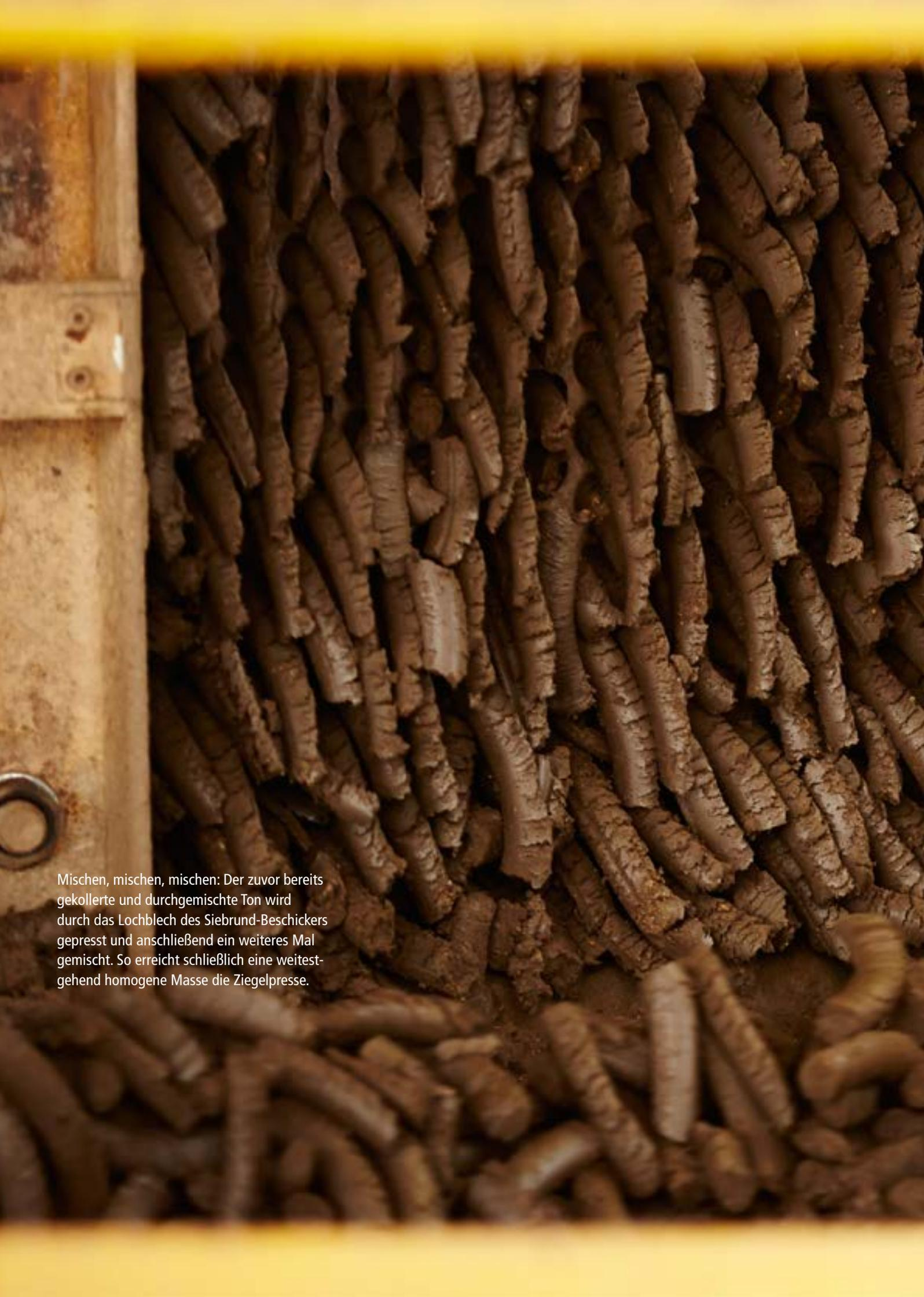
Mischen, mischen, mischen: Der zuvor bereits gekollerte und durchgemischte Ton wird durch das Lochblech des Siebrund-Beschickers gepresst und anschließend ein weiteres Mal gemischt. So erreicht schließlich eine weitestgehend homogene Masse die Ziegelpresse.
