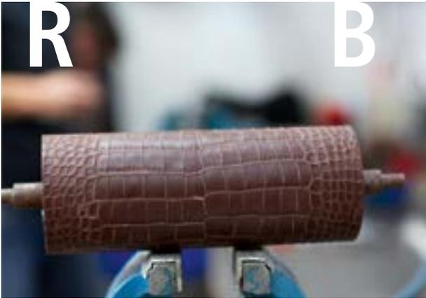
Das charakteristische Kroko-Relief einer fertigen „Läuferrolle“.
