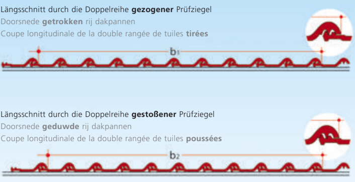
Orientierungs-Deckbreiten (cm) nach Anzahl der Ziegelreihen ohne GOZ oder Doppelkremper Dekbreedte (cm) met he aantal rijen dakpannen (ter orientatie) Largeurs de couverture d’orientation (cm) en fonction du nombre de rangées de tuiles
