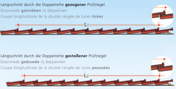
Orientierungs-Decklängen (cm) nach Anzahl der Flächenziegelreihen (ohne GOZ) Latafstand (cm) met he aantal rijen pannen (ohne gevelpannen) Longueurs de couverture (cm) en fonction du nombre de rangées de tuiles (sans tuiles de rive)
